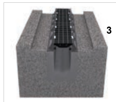
3- FISSARE LE GRIGLIE NEI LONGHERONI CON BULLONI DI FISSAGGIO 3-FIX THE GRATINGS TO THE FRAMES WITH ASSEMBLING BOLTS
