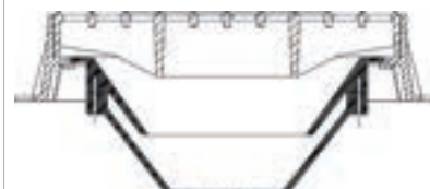
Particolare della connessione sifone-telaio Detail of the connection siphon-frame
