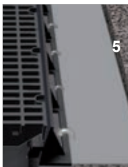
5- INSERIRE DELLE ZANCHE IN FERRO NEI FORI ESTERNI DEL TELAIO COSI' DA RENDERE SOLIDO IL TELAIO CON IL CANALE 5- INSERT IRON CLAMPS IN THE OUTER HOLES OF THE FRAME, IN ORDER TO GIVE CHANNEL AND GRATING STRENGTH.
